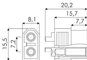
Il connettore grazie al suo corpo in nylon garantisce un solido collegamento ad alte temperature, ideale per le applicazioni di modellismo.
