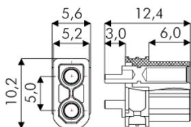
Il connettore grazie al suo corpo in nylon garantisce un solido collegamento ad alte temperature, ideale per le applicazioni di modellismo.
