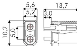
Il connettore grazie al suo corpo in nylon garantisce un solido collegamento ad alte temperature, ideale per le applicazioni di modellismo.
