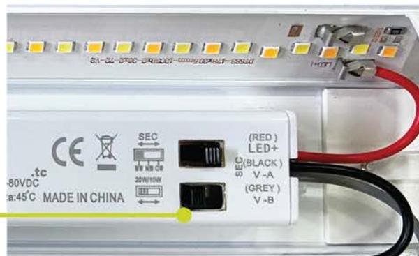
Grazie al comodo selettore posto sull'alimentatore sarà possibile scegliere la temperatura colore desiderata (2700K-4000K-6500K). Inoltre tramite un secondo selettore sarà possibile scegliere la potenza emessa (20W/40W).
