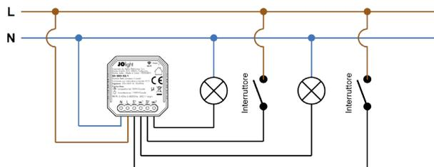
Lo switch 23-203-S2/1 ti permette di rendere il tuo interruttore intelligente. Semplicemente collegando il dispositivo e sostituendo l'interruttore esistente con un pulsante potrai accendere e spegnere il carico tramite il pulsante stesso e anche tramite l'app Smart Life Tuya (disponibile per Android e iOS).
