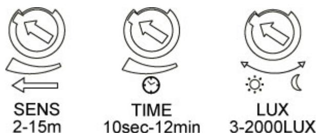
E' possibile regolare le impostazioni del sensore tramite 3 manopole:
