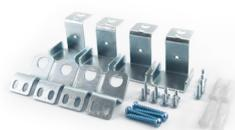
Set di accessori composto da 4 staffette per l'installazione a soffitto. I quattro ganci di alluminio consentono di fissare il pannello a una distanza di circa 50mm dal soffitto.
