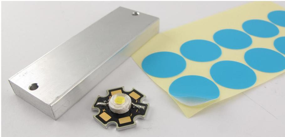
1. Utilizzando alcool isopropilico pulire le superfici di incollaggio. E' consigliato l'alcool isopropilico poiché non lascia aloni ne tracce di altre sostanze coloranti o organiche.
