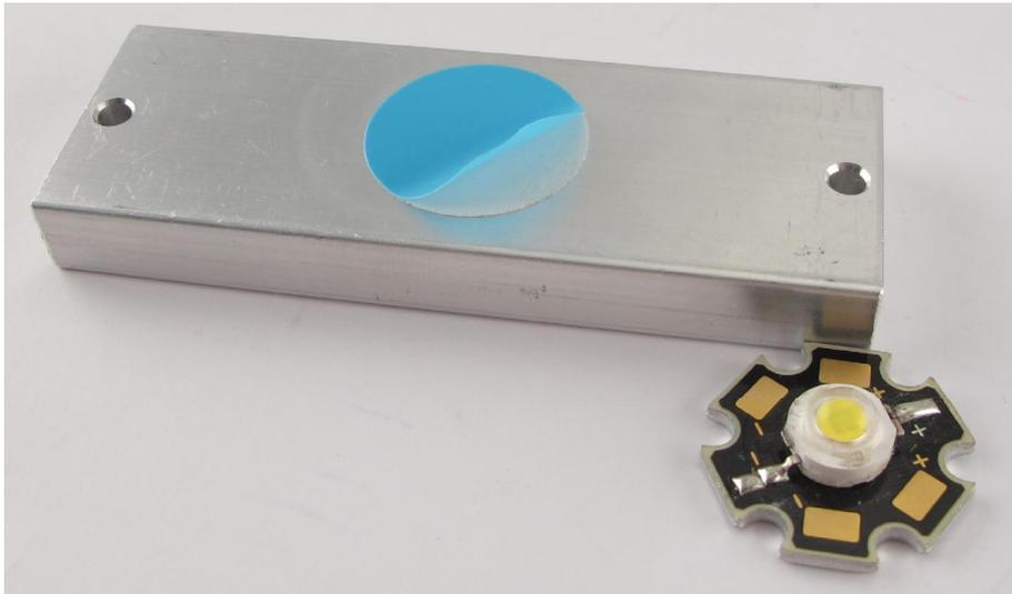
4. Posizionare il led di potenza ed applicare una leggera pressione in modo che il collante a base acrilica aderisca.
