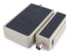
Il 94-103 è uno strumento indispensabile per l'installazione e la manutenzione di qualsiasi tipo di rete LAN. Adatto per testare la continuità del cavo e la corretta polarità dei connettori.
