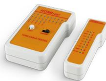
Il 94-110 è uno strumento indispensabile per l'installazione e la verifica di cavi audio-video HDMI. Adatto per testare la continuità del cavo e la corretta polarità dei connettori.
